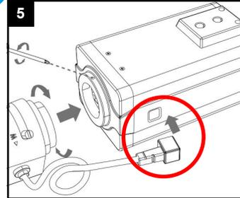
Bei Objektiven mit DC-gesteuerte Blende: 4-poligen Stecker anschließen.
