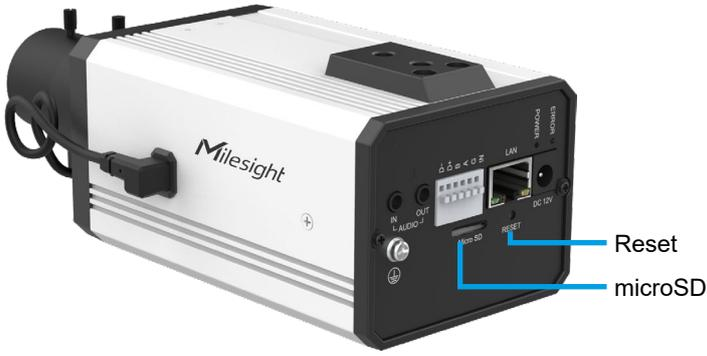
Für einen Reset: Betätigen Sie die Reset-Taste fünf Sekunden lang, wenn Sie die Kamera auf ihre Werkseinstellungen zurücksetzen möchten.
