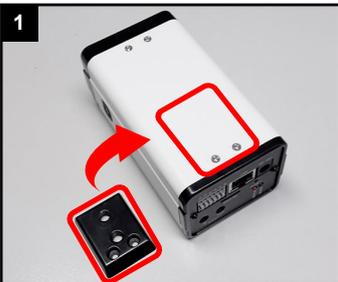
Adapter auf Ober- oder Unterseite der Kamera schrauben
