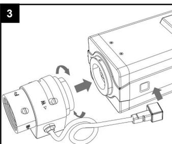
Passendes Megapixel-Objektiv auf die Kamera schrauben.
